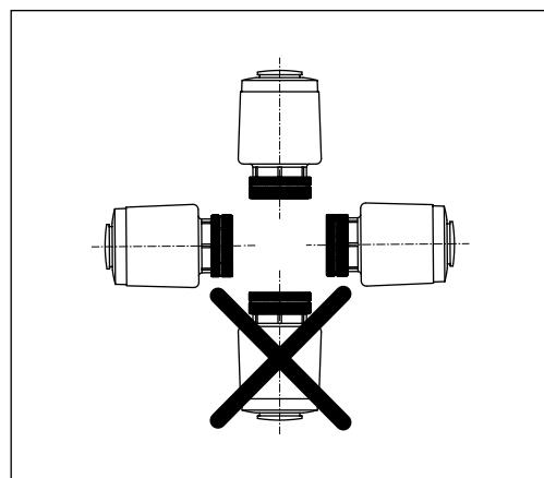
Привод должен быть закреплен на клапане либо горизонтально, либо вертикально сверху. После установки привода на клапане VZL фиксирующее кольцо удаляется вручную без использования какого-либо инструмента.
