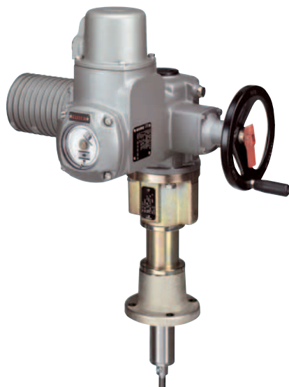
Полноповоротный привод SA/ SAR с блоком управления линейными перемещениями LE сила тяги: от 4 кН до 217 кН длина хода до 500 мм скорость позиционирования от 20 до 360 мм/мин
