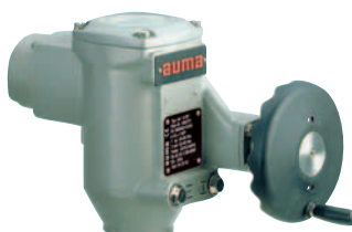
Неполноповоротный привод AS 6 – AS 50 крутящий момент от 25 до 500 Нм время позиционирования дл 90° от 4 до 90 сек.
