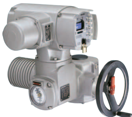
Полноповоротный привод SA/ SAR с узлом управления AUMATIC крутящий момент от 10 до 1000 Нм число оборотов от 4 до 180 в мин.
