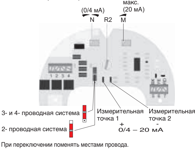
рис. O1: Плата электронного указателя положения
